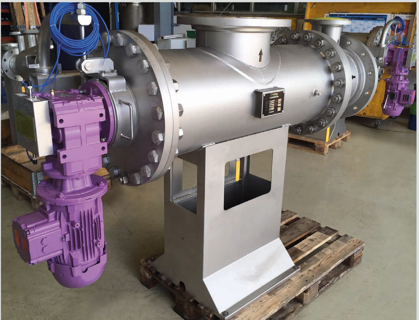
Abbildung 4: Lenzing Filtration entschied sich für die Verwendung von WG20-Getriebemotoren in ATEX-Ausführung mit druckfestgekapselte ATEX-Motoren W22X de
